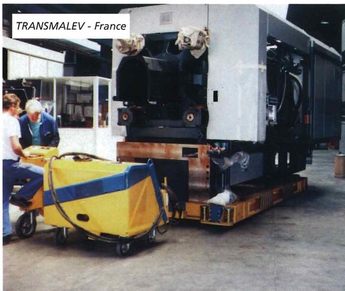
La TORTUE est munie de roues escamotables permettant de rouler RAPIDEMENT sur sol dur et plan.
