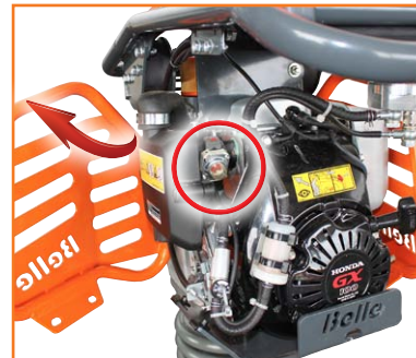
Protections moteur amovibles Carburateur avec système d'amorçage Moteur avec sécurité d'huile
