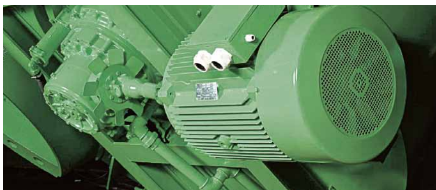
Entraînement par train planétaire et pompe hydraulique bridée.
