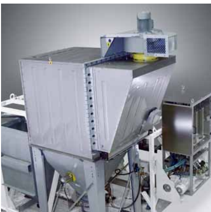
Évacuation forcée par aspiration du malaxeur
