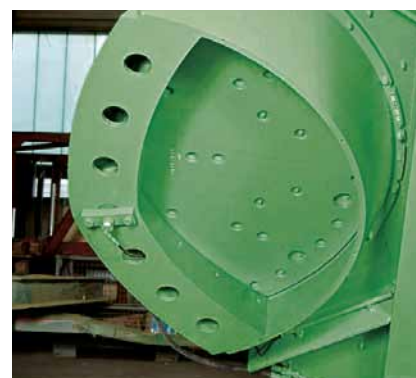
Dispositif de fermeture grandes dimensions avec vanne à commande hydraulique pour une vidange rapide.
