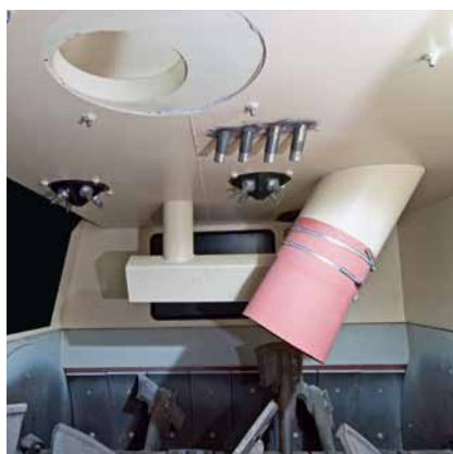
Têtes gicleuses pour le nettoyage de l'espace de malaxage.
