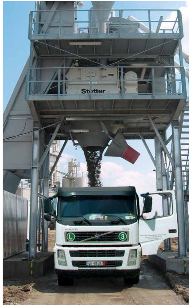
Chargement sur camion ouvert.
