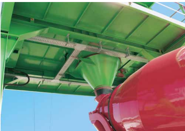
Le cône d'écoulement pour les malaxeurs de béton préfabriqué.
