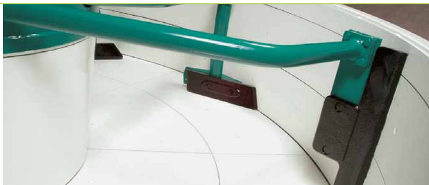
Illustration en haut à gauche et à droite. Les racleurs intérieur et extérieur favorisent le malaxage et la distribution des granulats.
