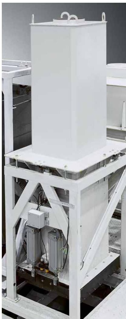
Basculé à glace pour le pesage de glace en flocons.
