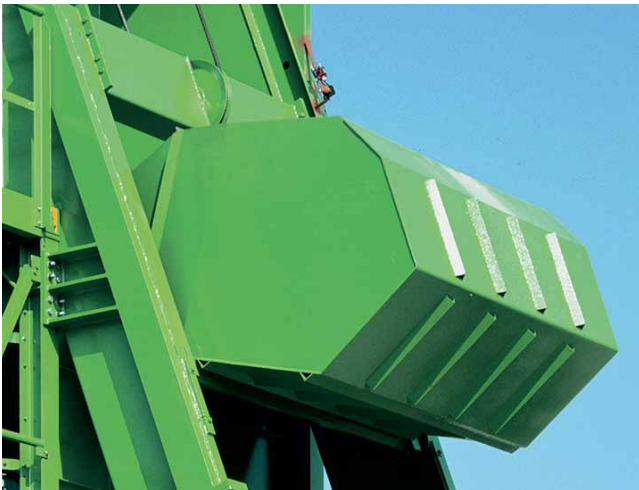
Le chargeur grandes dimensions et de forme optimale garantit une vidage complète.
