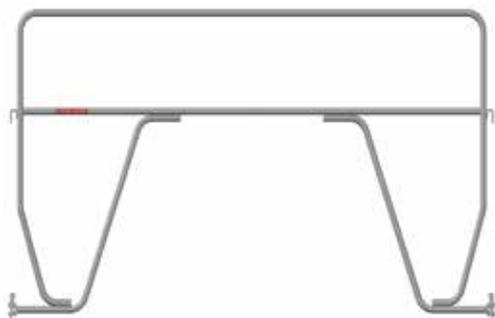
Fabriqués avec un tube de Ø 35 mm, ils sont conçus pour être montés depuis le niveau immédiatement inférieur de l'échafaudage, ce qui permet un montage sûr, puisque le travailleur est toujours protégé par le garde-corps définitif habilité. Ils sont galvanisés à chaud avec une épaisseur minimale de 75 microns. Ils évitent d'avoir d'utiliser des diagonales lorsque les montages sont peu élevés, puisqu'ils sont ancrés à la structure en 4 points (2 centreurs à clavette et 2 crochets).
