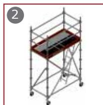
Exemple d'utilisation d'un garde-corps provisoire de montage.
