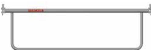
Fabriqués avec un tube de Ø 48,3 mm, ils permettent une économie de poids et de temps pendant le montage. Ils sont galvanisés à chaud avec une épaisseur minimale de 75 microns. Barre de protection à 0,5 m dotée d'un tube de Ø 25 mm.
