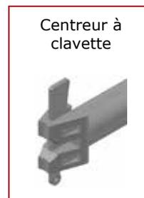
Fabriqués avec un tube de  $\varnothing 48,3$  mm, ils sont munis sur les deux extrémités de centreurs à clavette qui s'insèrent dans les petits orifices des rosaces. Ils sont galvanisés à chaud avec une épaisseur minimale de 75 microns. Ils servent de garde-corps (s'ils sont montés à 0,5 m et 1 m au-dessus des planchers) et d'appui pour les planchers.
