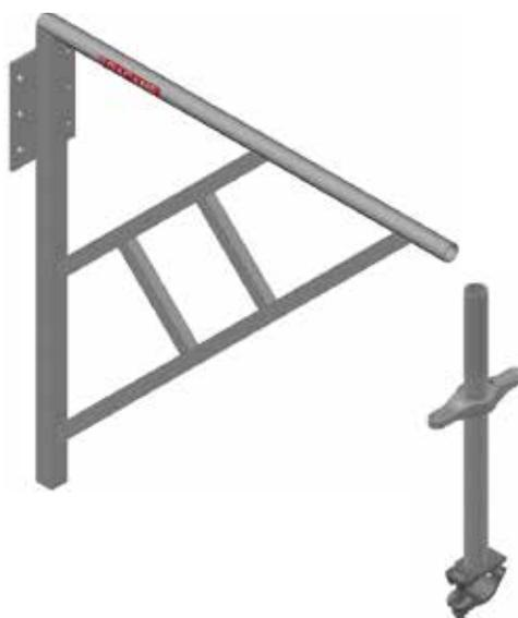
La console murale renforcée est fabriquée en acier galvanisé à chaud. Elle permet de monter l'échafaudage sur un mur ou sur une façade, par le biais d'amarrages chimiques ou mécaniques. Elle est composée d'une plaque renforcée munie de 6 douilles de Ø 20 mm pour le montage.
