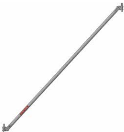
Fabriquées avec un tube de  $\varnothing 48,3$  mm, elles sont munies de centreurs sur leurs deux extrémités. Leur rôle est de stabiliser les plans verticaux formés par les montants verticaux et les lisses. Elles sont galvanisées à chaud avec une épaisseur minimale de 75 microns.
