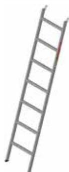
Fabriquée en aluminium 6061. Conformément aux normes EN 131-1 et 2. Crochets sur la partie supérieure et taquet en caoutchouc antidérapant. Largeur de passage des marches : 40 cm.
