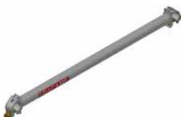
Fabriqués avec un tube de  $\varnothing 48,3$  mm, ils sont équipés de 2 colliers pour tube de  $\varnothing 48,3$  mm et ils sont employés pour pouvoir appuyer les planchers sur les échafaudages utilisant des poutres de franchissement. Ils sont galvanisés à chaud.
