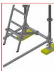
Il permet de donner l'inclinaison souhaitée à l'échelle du premier plancher d'accès, sans besoin d'utiliser des planchers en acier au niveau initial. Raccord sur le lisse via un collier de  $\varnothing 48,3$  mm. Il est galvanisé à chaud avec une épaisseur minimale de 75 microns.
