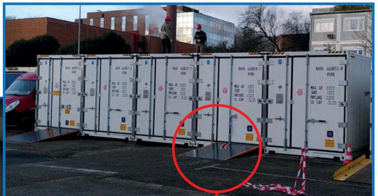
Rampe sur mesure pour chariot électrique
