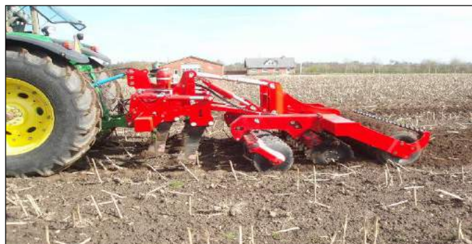
Combi-Disc avec dents relevées. Seule la fonction de déchaumage est employée.
