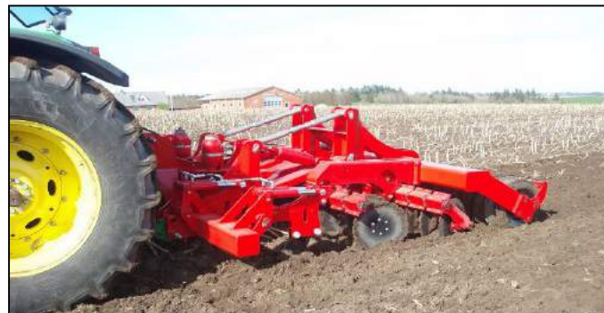
Combi-Disc avec dents au maximum. Décompactage, déchaumage et retassement combinés.
