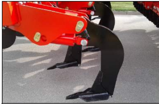
Conception de la dent Combi-Disc et Combi-Tiller MKII
