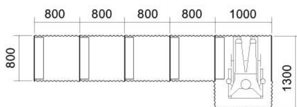
MONTAGE EN BATTERIE OU ISOLEE
