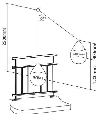
Un sac de 50kg maintenu par des poulies est placé à 1200 mm et 65° au dessus du garde-corps depuis son centre, puis lâché jusqu'à l'impact.
