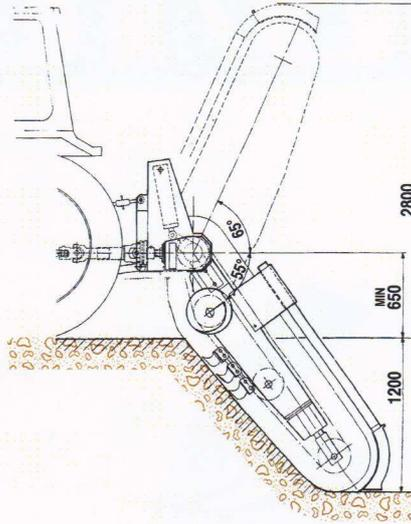
Attrezzo per l'esecuzione di trincee su materiale vegetale compatto. Il gruppo di scavo viene montato sul sollevatore con attacco a tre punti ed azionato dalla presa di forza a 540 giri/min di qualsiasi trattore da 60-120 cv in grado di consentire una velocità di circa 300 m/h con motore a regime e dotato di un distributore idraulico a doppio effetto per il cilindro del sollevamento del braccio.
