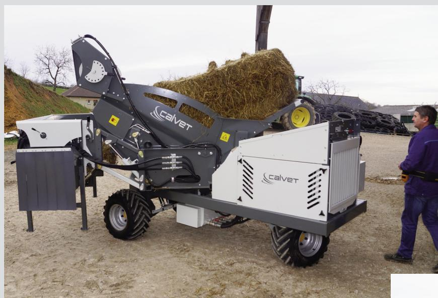
Caisse pivotante hydraulique, permet de pailler en rotation et de distribuer les balles à droite et à gauche. La caisse inclinable facilite le chargement des balles rectangulaires et la distribution en relevant la caisse. Roue directrice avec rotation 180°, la machine tourne sur place.
