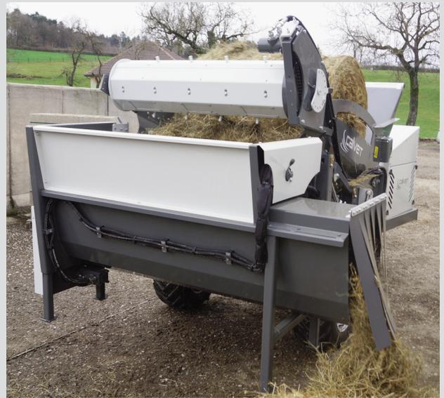
Distribution de balles enrubannées avec la vis ou directement en pivotant la caisse à droite ou à gauche
