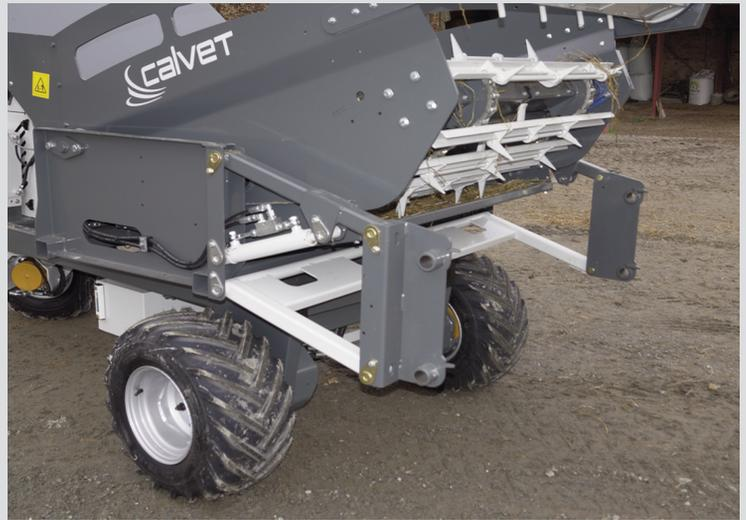
Tablier à accrochage rapide des outils à parallélogramme hydraulique solidaire du pivotement de la caisse à 180°
