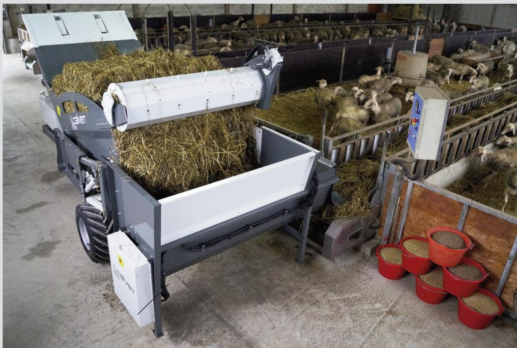
La vis de distribution de 400mm canalise et compacte le foin et l'enrubannage sur les tapis mécanisés. Un contrôle d'effort sur la vis permet de réguler l'avancement du tapis. La caisse inclinable permet, en fonction des balles, d'avoir plus de dégagement par rapport à la vis avec un produit long. Le dispositif à vis de distribution peut être ajusté en hauteur grâce au porte outil à parallélogramme.
