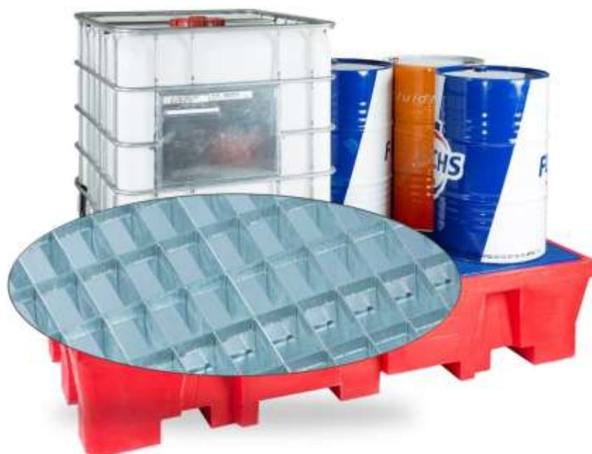
Les bacs de rétention en plastique sont particulièrement adaptés aux acides et bases. Conçu en polyéthylène avec un caillebotis galvanisé à chaud, ils regroupent de nombreux avantages : légèreté, facilité de nettoyage, longévité, résistance à la corrosion et aux produits chimiques. Le bac de rétention MRG-BI est adapté au stockage de 2 cuves de 1000 litres ou de 8 fûts.
