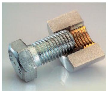
Ensat est une douille filetée auto-taraudeuse avec un filetage extérieur. Elle est dotée d'une fente ou de trous coupants. Notre longue expérience nous a permis d'apporter de nombreuses améliorations sur le produit qui sont protégées par des brevets à travers le monde.
