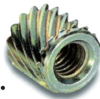
Mubux-Z est une douille taraudée en acier trempé zingué, à monter à la presse grâce à sa denture extérieure hélicoïdale.
