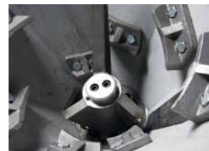
Compartiment de broyage avec arbre de broyage
