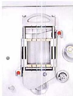
**2** Les grilles supérieures et inférieures se placent sur des goujons de maintien et se fixent au moyen de leviers.
