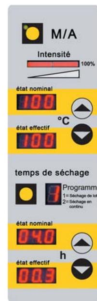
Clavier de réglage HELIOMAT®-Station de pré sèchage.
