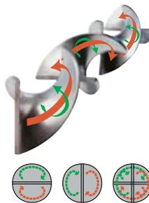
2 : En créant une circulation hydraulique autour de chaque élément de mélange. Cette méthode fonctionne aussi bien en débit laminaire que turbulent.
