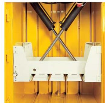
Les verins à cisailles assurent un compactage homogène et une faible hauteur totale.
