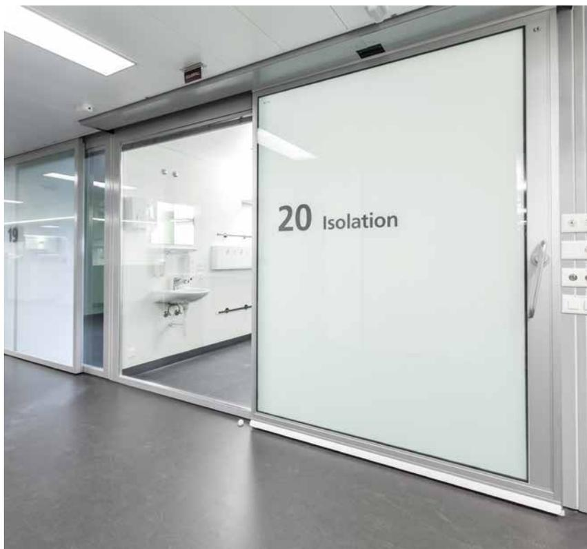
La porte coulissante hermétique Gilgen scelle automatiquement votre pièce de manière étanche, empêchant les échanges indésirables d'air, de corps étrangers et d'impuretés. Lors de la fermeture de la porte, le mécanisme de pivotement de l'unité d'entraînement abaisse le vantail et le presse contre l'encadrement de la porte. Ce mouvement d'abaissement, associé aux joints d'étanchéité, assure la fermeture hermétique de la porte.
