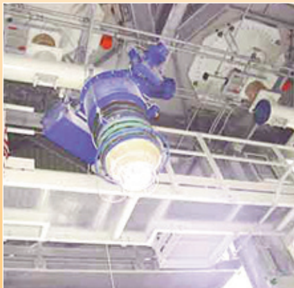
Manche avec filtre dépoussiéreur incorporé
