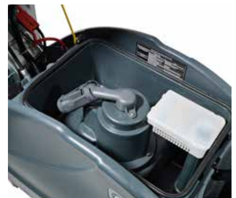
Réservoir de 44 litres permettant un temps de travail de 75 minutes
