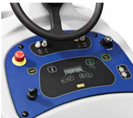
Le tableau de bord intuitif, le bouton "one touch" et le menu simple d'utilisation font de la SC1500 une auto-laveuse facile à utiliser y compris pour des opérateurs novices
