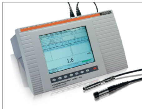
FISHERSCOPE® MMS® PC, système de mesure unique pour la mesure d'épaisseur de revêtement et l'analyse générale des matériaux intégrant différentes méthodes telles que le magnétisme, l'induction magnétique, les courants de Foucault et la rétrodiffusion Béta
