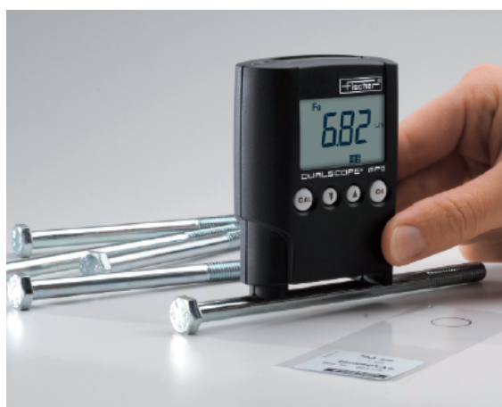
Mesure de zinc sur fer. Sur des échantillons de petits diamètres, une calibration corrective est recommandée pour obtenir des mesures justes
