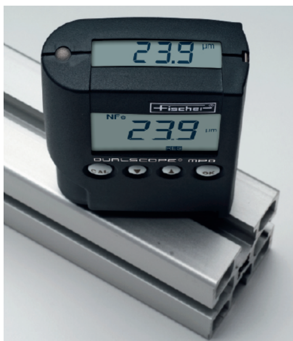
Couche d'anodisation sur aluminium
