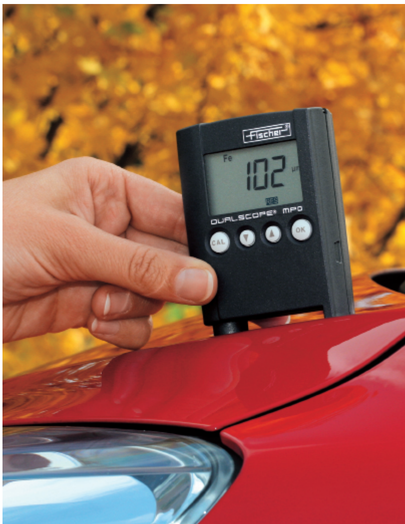
Exemple d'inspection d'un revêtement de peinture avec un DUALSCOPE® MPO, dans le domaine de l'expertise de carrosserie automobile
