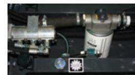
Réservoir d'huile hydraulique incorporé au châssis
