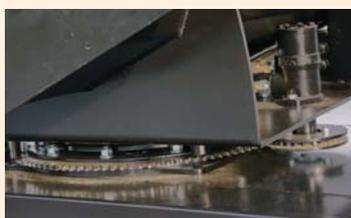
**Ensemble pignon / couronne** animé par un moteur hydraulique : garantie d'un mouvement régulier.
