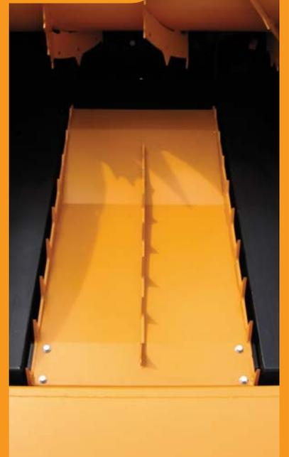
**Fond alternatif breveté** entraîné par moteurs hydrauliques. Absence de chaîne et de pignon : pas d'entretien.
