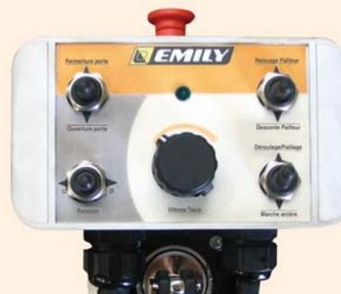
**Boîtier électrique** ergonomique commandé en cabine, avec molette pour ajustement de la vitesse tapis. Maintien du boîtier par ventouse de fixation.
