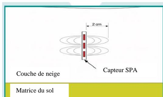
**Base de la mesure de constante diélectrique**
