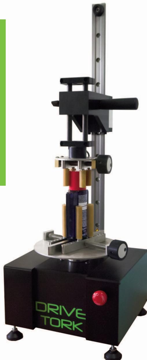
Pour réaliser une mesure de couple précise et répétitive, il est souvent nécessaire d'utiliser un banc de torsion disposant d'une vitesse constante programmable. Le torsiomètre motorisé vertical Drivetork permet de réaliser ses mesures en s'affranchissant de l'influence de l'opérateur grâce à une rotation régulée à vitesse constante.
