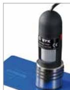
La coupe en V peut être facilement stockée et mesurée sous forme d'image avec le microscope numérique de poche. Pour plus de détails, voir le chapitre "Microscopes", pages 221 - 223.
