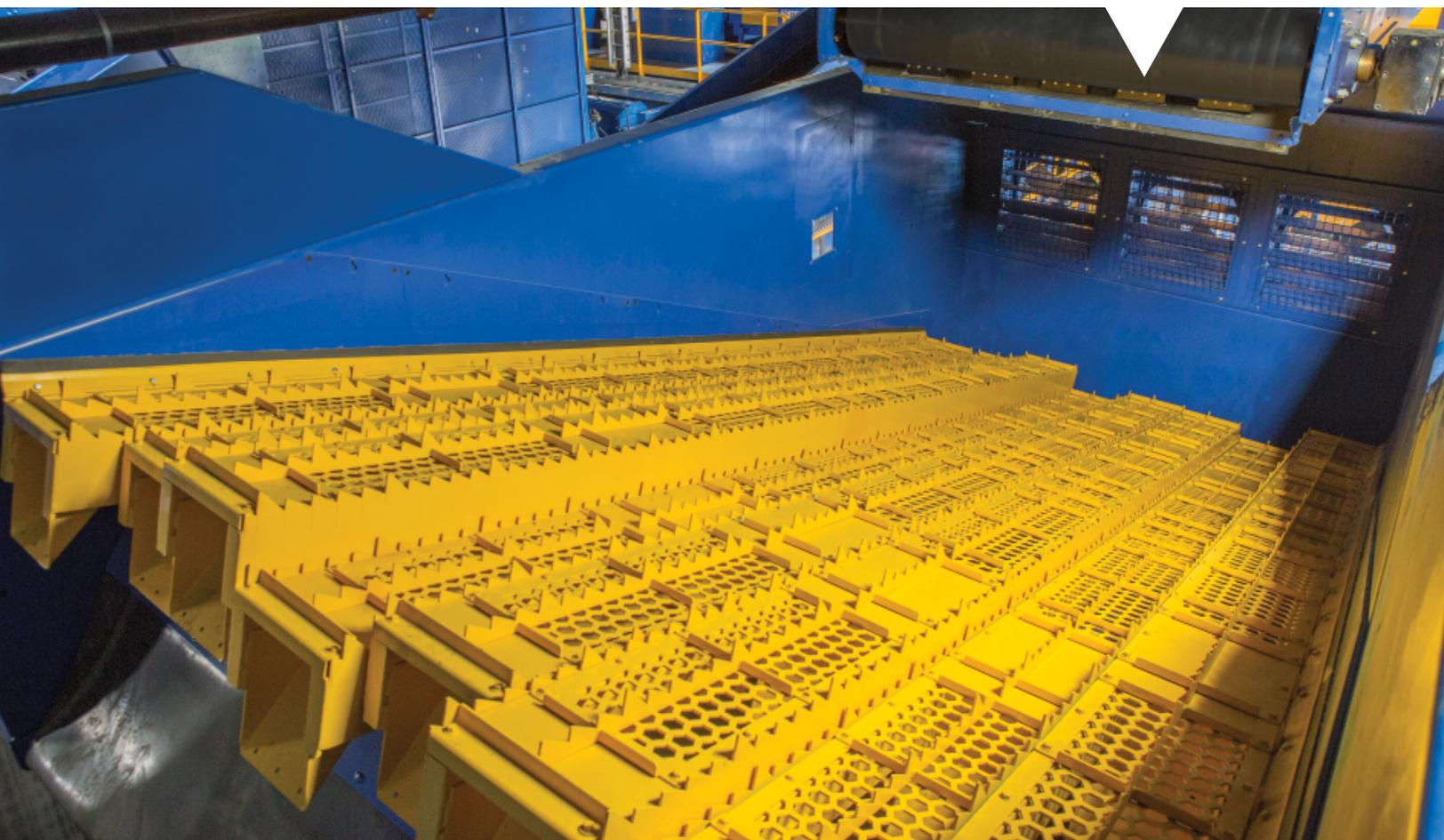
Le MACH Ballistic est conçu pour trier les corps plats (pellicule plastique, papier, cartons et autres fibres) des corps creux (contenants, bouteilles de plastique, cannettes de métal, pierre, bois, etc.). Les corps plats remontent la pente du séparateur, tandis que les corps creux rebondissent sur les lattes et roulent vers le bas. Les particules fines peuvent être retirées par les ouvertures de dimensions variables sur les lattes.
