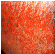
Zone blanche (Martensite / cémentite) Surface après érosion
