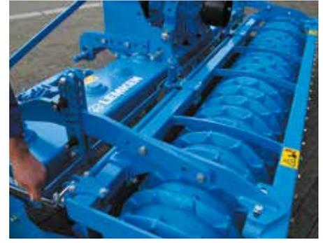
**Barre de nivellement pour réguler le flux de terre**
