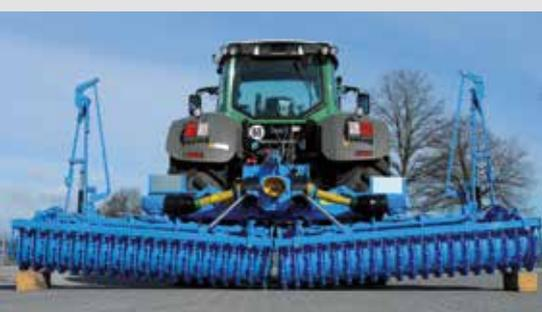
**Adaptation au sol optimale grâce à la fixation centrale en pendulaire**
