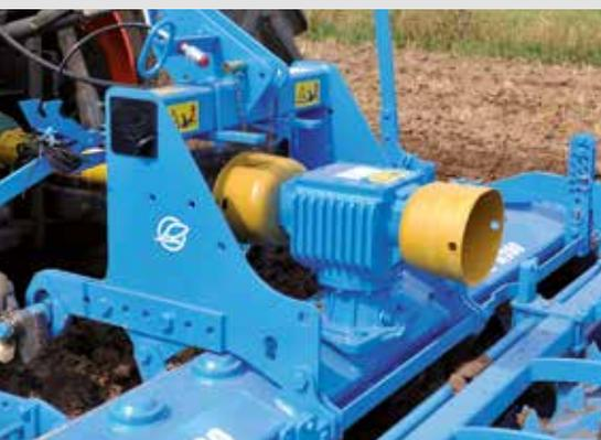
**Transmission simple grâce au couple conique interchangeable**
