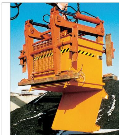
BC avec déverrouillage du fond par pinces lève-blocs
