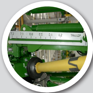
REGLAGE DE LA LARGEUR DEPUIS LE POSTE DE CONDUITE
