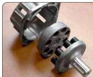
Joint élastique pour un meilleur accouplement de la pompe (modèle triphasé)
