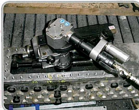
Usinage de bride rectangulaire sur aéro-réfrigérant
