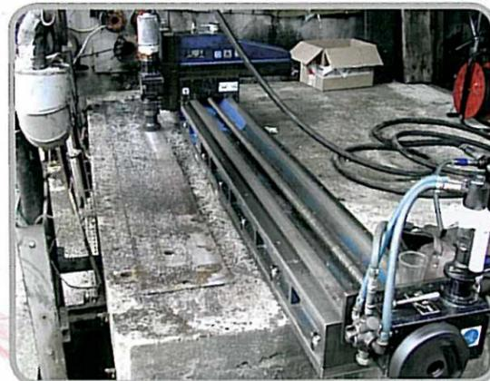
Fraisage de châssis moteur
