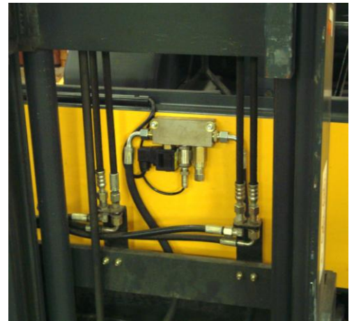
Bloc commande hydraulique avec capteur à pression d'huile et régulateur de débit
