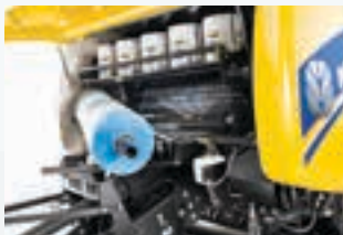
Support intégré pour installer un rouleau de filet depuis le sol.
