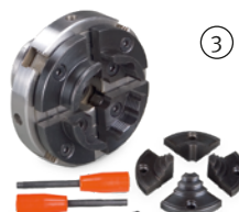
Fig. : Kit mandrin 4 mors · Ø 100 mm · Mors interchangeables · En option
