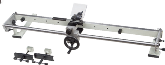
Fig. : Copieur pour DB 900/1100 · Permet de dupliquer une pièce en plusieurs exemplaires à partir d'un modèle existant (pieds de chaises, balustres, etc.) · Permet un gain de temps très appréciable. · Bâti rigide en aluminium, chariot en fonte et barres de guidage en acier. · A monter
