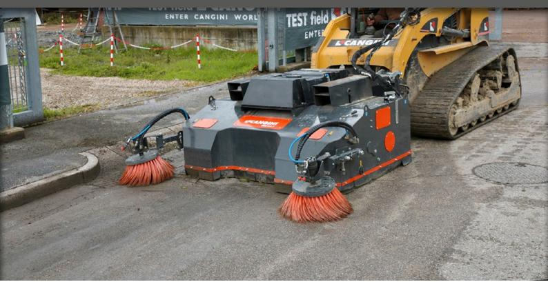
LA BALAYEUSE UNIVERSELLE EST ADAPTÉE À LA MAINTENANCE ET LE NETTOYAGE D'ESPLANADES, PAVAGES, HANGARS INDUSTRIELS, ROUTES OU SURFACES OÙ LE NIVEAU DE FINISSAGE RÉQUIS EST HAUT. ELLE PEUT ÊTRE ATTACHÉE AUSSI AU CHARIOT ÉLÉVATEUR. LA SÉRIE 3. EST ÉQUIPÉE DE 4 ROUES PIVOTANTES POUR ÉVITER LE CONTACT DU FOND DU GODET AVEC LA SURFACE NETTOYÉE POUR NE L'ENDOMMAGER PAS. TOUS LES MODÈLES SONT CONÇUS POUR ÊTRE COMBINÉS
