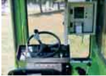
Il permet de contrôler avec précision la quantité de chaque composant introduit dans la cuve de malaxage. Grâce à son imprimante, le système s'avère particulièrement utile pour tous travaux dont les spécifications contenues dans le cahier des charges imposent une qualité de béton certifiée.
