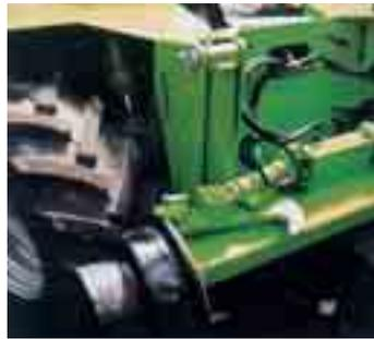
Il permet à la machine de se déplacer de façon autonome partout, y compris sur des rails, grâce à deux essieux ferroviaires à relèvement hydrauliques.
