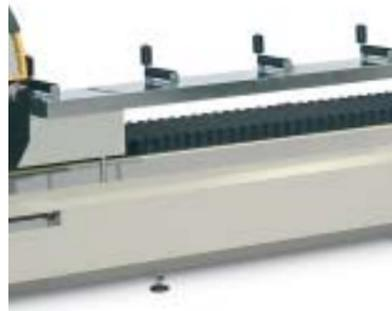
Le chemin d'amenage peut être raccordé au support mobile du profilé le long de l'axe longitudinal et équipé d'un système pneumatique pour le reset
