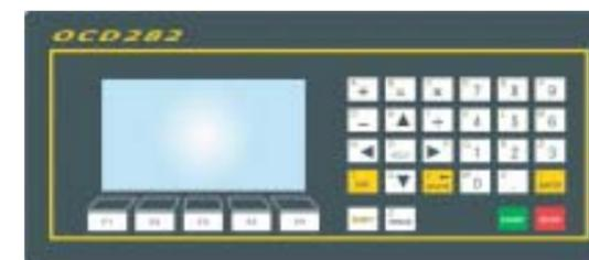
Système de contrôle de type industriel OCD 282 avec afficheur LCD
