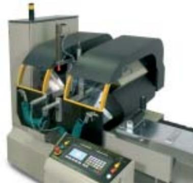
La structure particulière permet soit à DH 500 A que à DH 550 A d'effectuer une coupe min. de 320 mm avec les deux têtes inclinées à 45°
