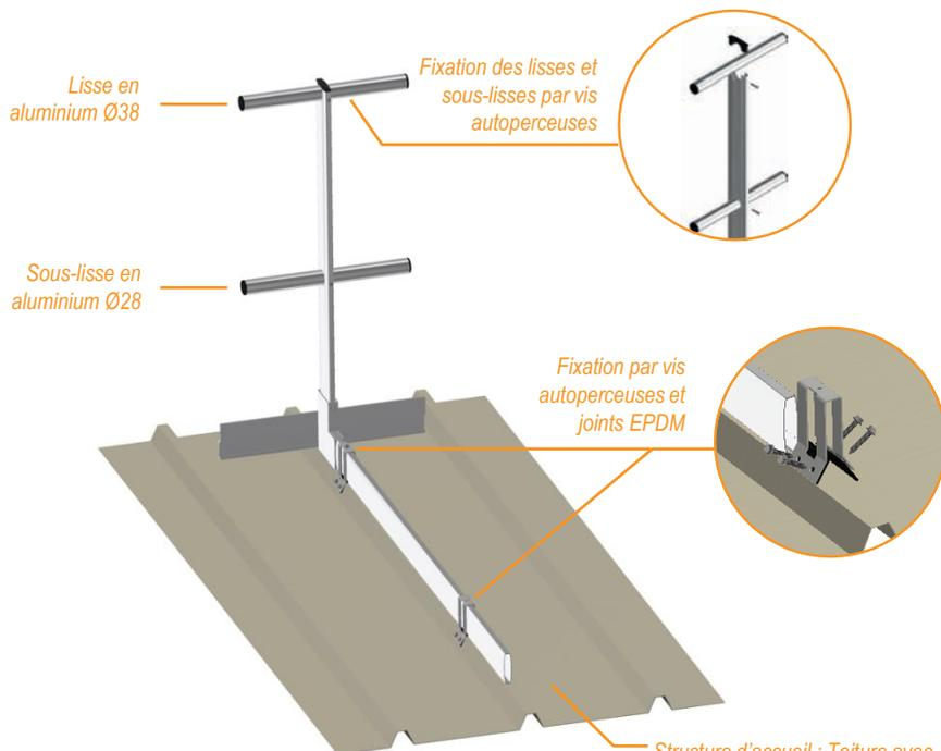
Structure d'accueil : Toiture avec couverture en bac sec d'épaisseur mini 0.63mm et hauteur d'onde maximum 50mm.
