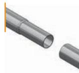
Raccordement des lisses par rétreint
