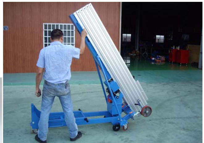
Basculement aisé du mât pour un transport dans le sens de la longueur
