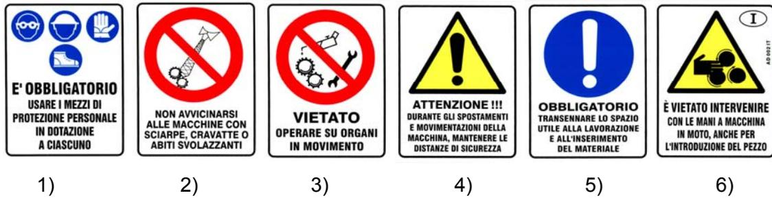
Figure 2.1 — Pictogrammes reportés sur la machine : 1) obligation d'utiliser les DSI ; 2) danger d'accrochage ; 3) obligation de délimiter l'espace utile pour le travail ; 4) défense d'intervenir sur des organes en mouvement ; 5) respecter les distances de sécurité ; 6) danger d'écrasement.
