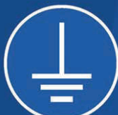
MISE À LA TERRE OBLIGATOIRE
