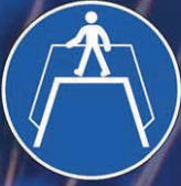
UTILISATION DE LA PASSERELLE OBLIGATOIRE
