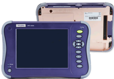
Le réceptacle modules se fixe à la partie avant de l'appareil comportant l'écran
