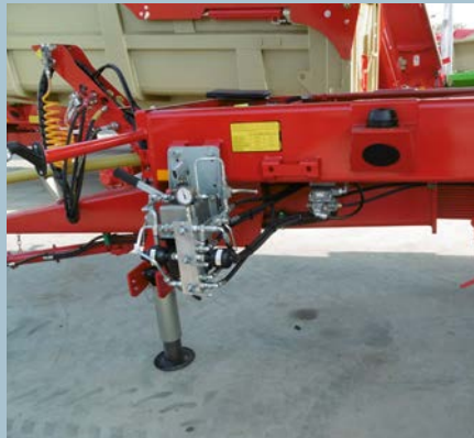
Essieu directionnel forcé avec vérin émetteur
