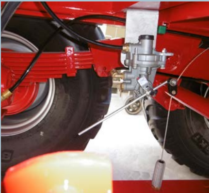
Freinage pneumatique avec correcteur auto
