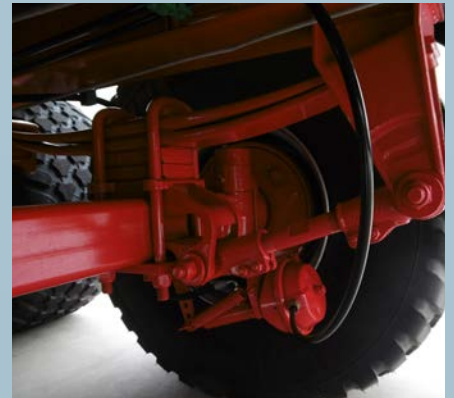
Freinage mixte : hydraulique et pneumatique
