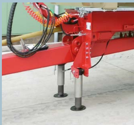
Double béquille hydraulique
