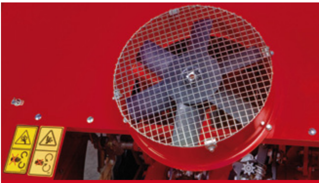
Ventilatore di pulizia del legatore. / Fan for twine binder cleaning. / Ventilador para la limpieza del atador. / Ventilateur nettoyage relieur.
