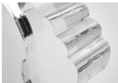
Bords de découpe nets de l'acrylique jusqu'à 25 mm
