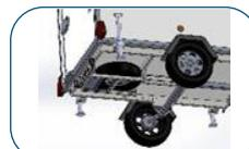
Roue de secours avec support et marchepied intégré coulissant
