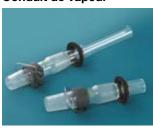
Conduit de vapeur continu et joint en matériau composite PTFE pour une longue durée de vie et une excellente étanchéité.
