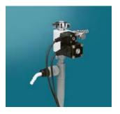
Principe de génération de vide simple, disponible avec ou sans soupape d'eau de refroidissement. Le régulateur de vide s'enclenche et s'arrête en fonction des besoins.
