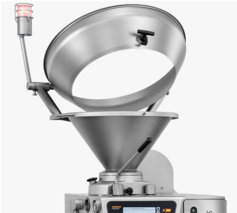
Trémie de remplissage 90/240 litres, divisible
